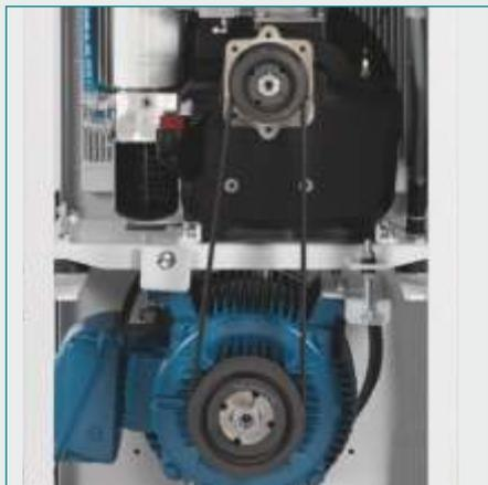
Die Riemenspannung erfolgt über eine Motorwippe. Durch die optimierte Umschlingung des Riemens um die Scheibe entsteht eine bessere Kraftübertragung.
